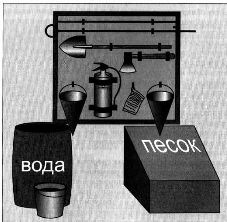
Рис. 5.1. Пожарный щит первичных средств пожаротушения
